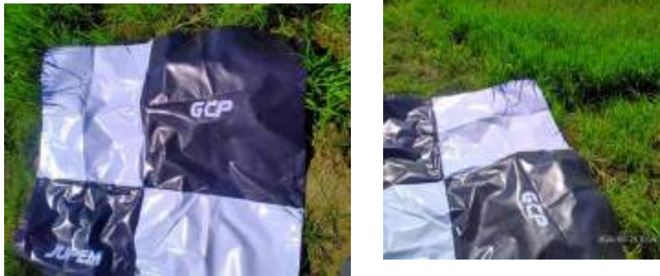
Rajah 3.4: Tanda GCP yang dibina berukuran 1mx1m
