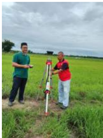
Rajah 3.5: Pemasangan peralatan GNSS di Lapangan
