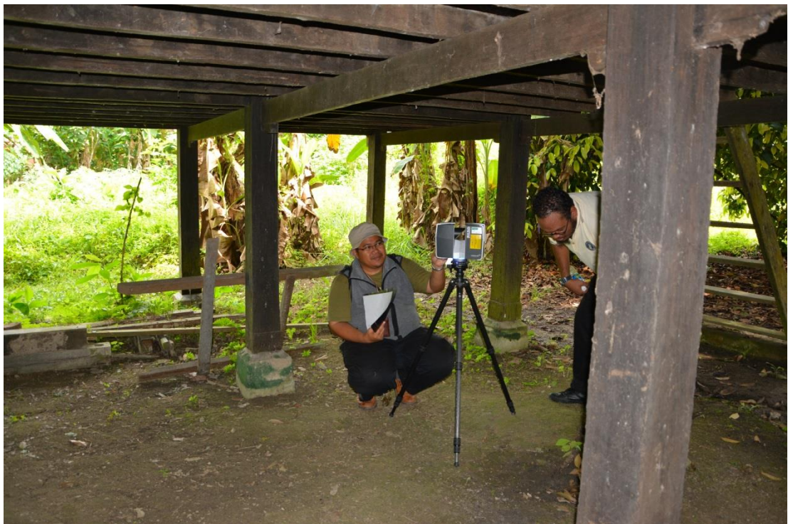
RAJAH 15: Mendirisiap alat pengimbas laser di stesen kerja yang telah dirancang
