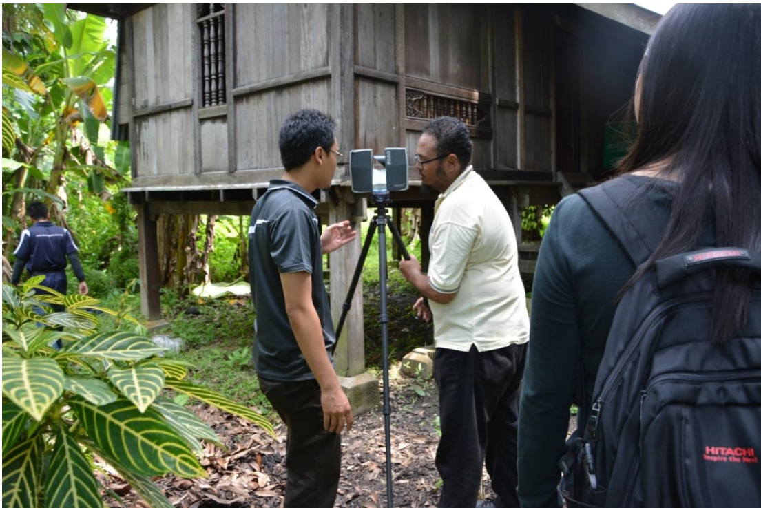
RAJAH 13: Mendirisiap alat pengimbas laser
