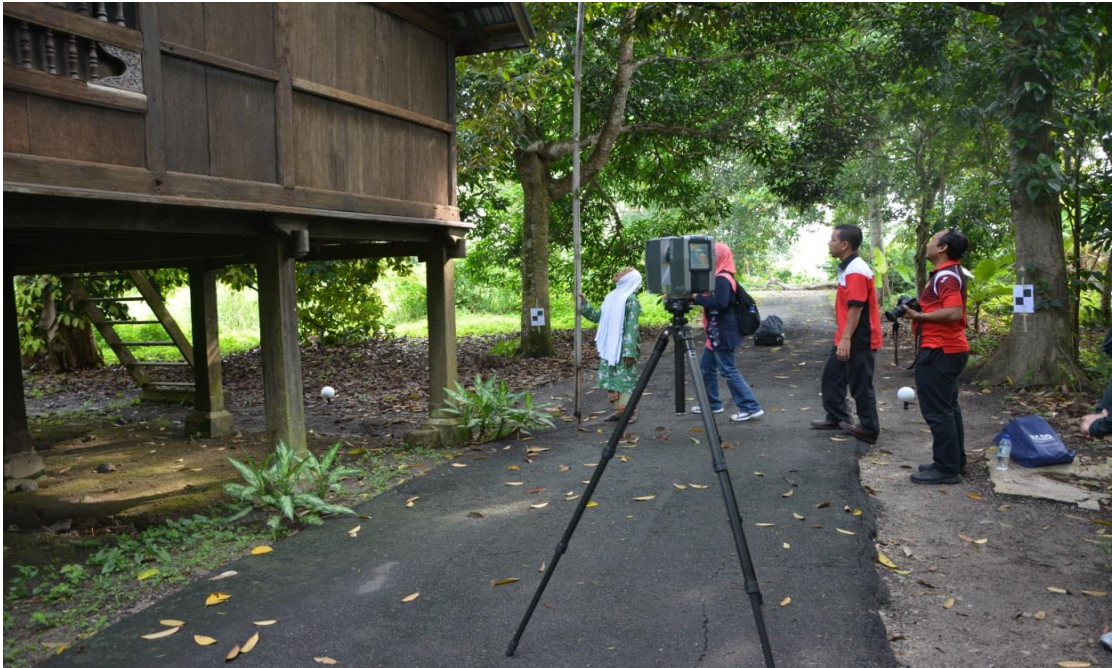
RAJAH 9: Memastikan tiada halangan yang akan berlaku ketika kerja-kerja pengimbasan dilakukan
