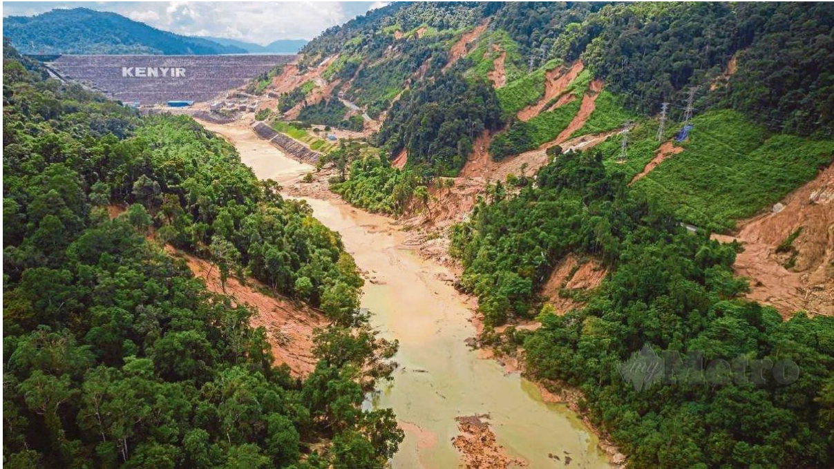
Kesan tanah runtuh selepas hujan lebat berdekatan Empangan Hidro di Stesen Janakuasa Kenyir Tenaga Nasional Berhad (TNB) di Jenagor. FOTO ARKIB NSTP
